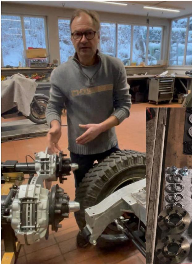
In diesem V8 Umbau/ Aufbau kommt zum ersten Mal eine unserer komplett neu aufgebauten Vorderachsen mit Scheibenbremsen zum Einsatz.
