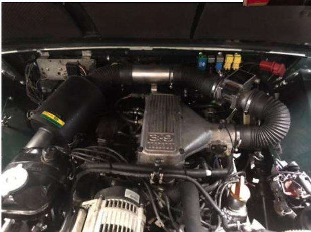
Desweiteren ist unser Serie 1 mit dem V8 Einspritzer Umbau und Automatik das erste Mal auf Probefahrt gewesen
