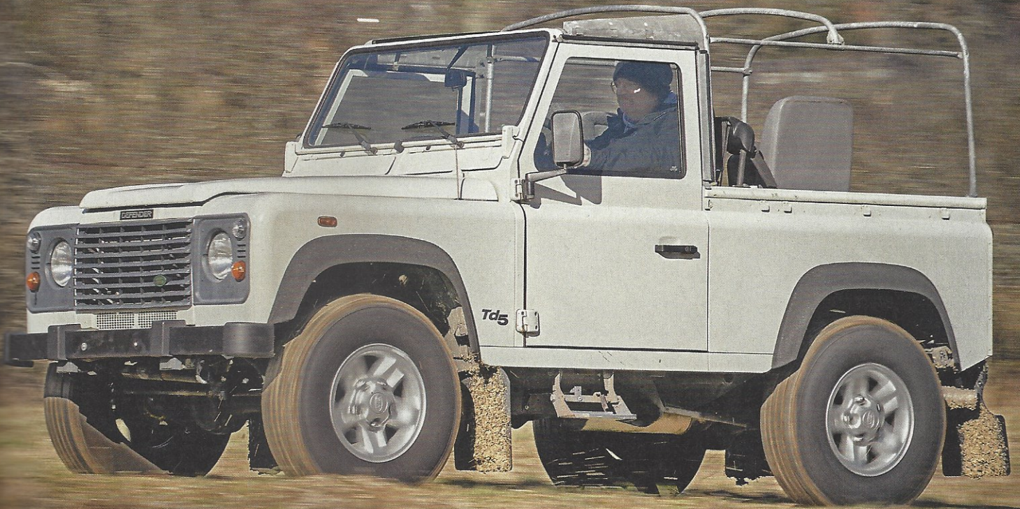
Traummaße 90/110/130: Den Defender gab es mit drei Radständen: Den 90 offen oder geschlossen, den 110 nur als geschlossenen Fünftürer, den 130 nur als Pick-up
