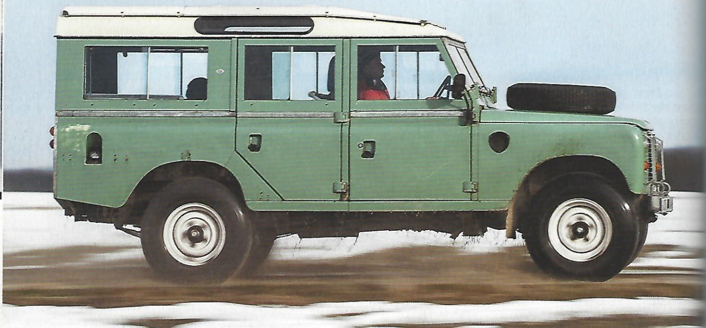
Funktion statt Emotion: Die Spaltaxt-Gestaltung mit geraden Flächen sollte schlicht Werkzeugkosten sparen. Das doppellagige Tropendach sorgt in der Tropenzone für einen kühlen Innenraum.
