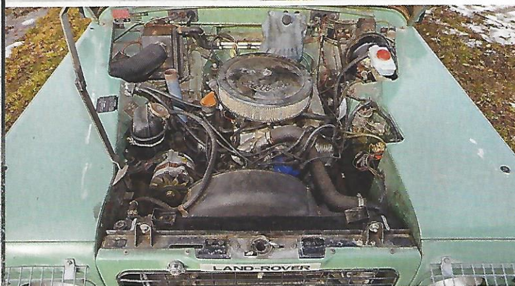
Der 144 Kilo leichte Alu-V8 entstand in den Fünfzigern bei Buick und wurde an Rover weitergereicht. Im Landy ist er von 135 auf 91 PS gedrosselt
