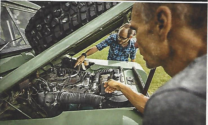
Im ersten und in den dreieinhalb letzten Jahrzehnten seiner Bauzeit hatte der Land Rover permanenten Allrad. Dazwischen: roten Hebel für die Untersetzung nach hinten, den gelben für den Allrad runterdrücken. Reihensechser mit 91 PS
